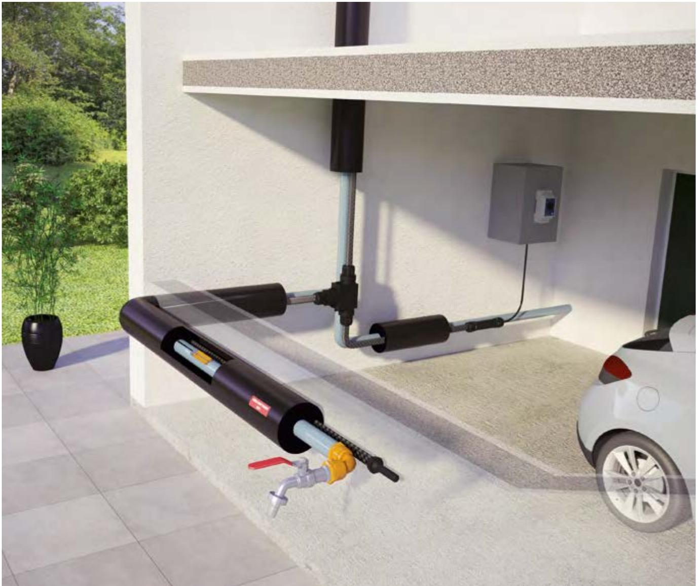
Le ruban **AUTOCÂBLE** se fixe simplement sur la tuyauterie, sous la mousse calorifuge, **idéalement sur la partie inférieure du tube**. On procédera par traçage rectiligne à raison de 1 m de câble par mètre de tuyauterie (pas de serpentins autour du tuyau).
